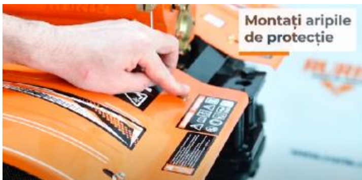
Montați aripile de protecție.
