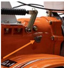
Fig. 5 – Verificarea nivelului de ulei al transmisiei
