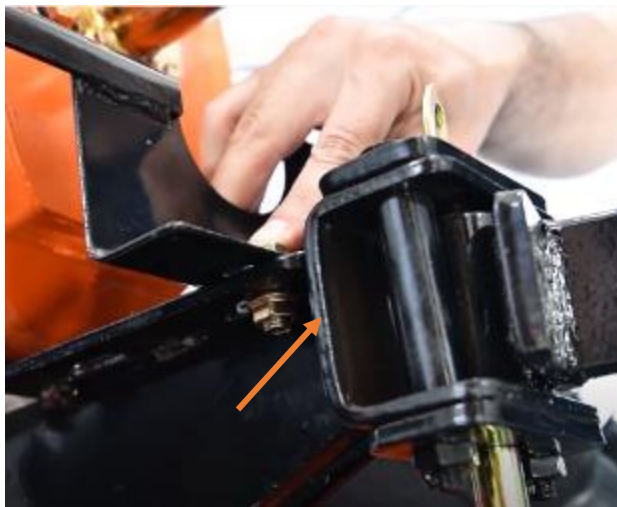
Монтира се задната опора на крилата.
