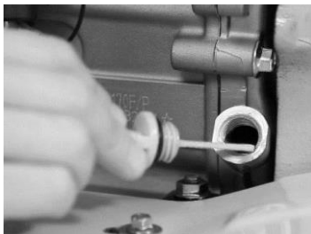
Фиг. 4 – Проверка на нивото на двигателното масло
