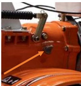
Слика 5 – Провера нивоа уља у мењачу
