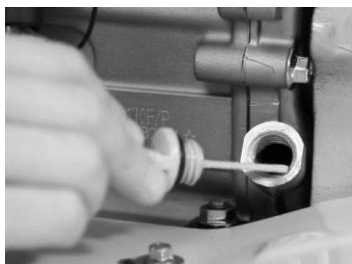
4. ábra – A motorolajszint ellenőrzése
