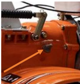
Фиг. 5 – Проверка на нивото на трансмисионното масло
