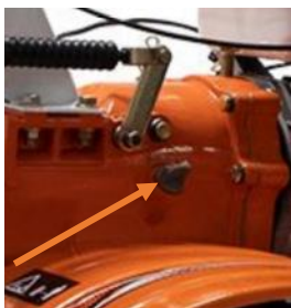
5. ábra – A sebességváltó olajszintjének ellenőrzése
