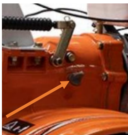
Fig. 5 – Verificarea nivelului de ulei al transmisiei
