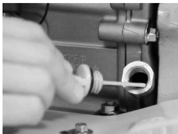
Rys. 5 – Sprawdzanie poziomu oleju silnikowego
