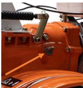
Fig. 5 – Verificarea nivelului de ulei al transmisiei
