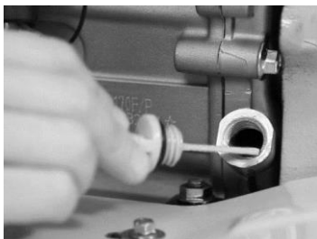
Fig. 5 – Verificarea nivelului de ulei la motor
