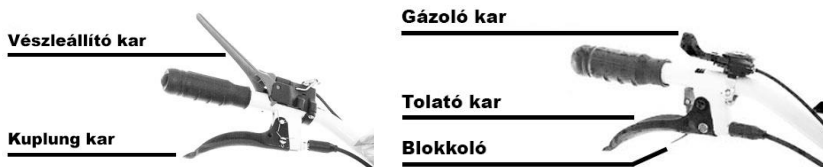
6 –Ábra- A kuplung kar beállítása és összeszerelése
