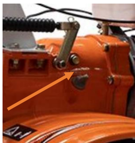
Провера нивоа уља у мењачу
