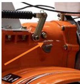
Verificarea nivelului de ulei al transmisiei
