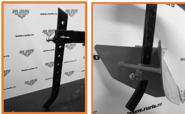
A mélységbeállító konzol és az eke a mellékelt csavarokkal csatlakozik
